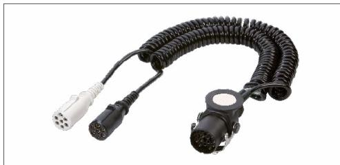
Les adaptateurs 24V sont utilisés pour la connexion entre un véhicule tracteur (équipé d'un socle 15P/24V selon ISO 12098) et une remorque (équipée de deux socles 7P/24V ; 1x type N selon ISO 1185 et 1x type S selon ISO 3731). Ces adaptateurs sont particulièrement utiles sur les nouveaux camions équipés d'origine avec des socles 15P/24. Ils permettent la compatibilité avec des remorques plus anciennes, équipées des systèmes 7P/24V.
